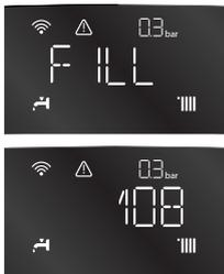
**NOTA 1 - PROCEDURA DI RIEMPIMENTO PER RIPRISTINARE LA CORRETTA PRESSIONE APRIRE IL RUBINETTO DI RIEMPIMENTO (POSIZIONATO NELLA PARTE INFERIORE DELLA CALDAIA) E PREMERE IL TASTO MODE PER 5 SECONDI. IL DISPLAY MOSTRA "AIRPURGE ATTIVA". QUANDO IL DISPLAY INDICA UNA PRESSIONE COMPRESA TRA 0,6 E 1,5 BAR, CHIUDERE IL RUBINETTO DI RIEMPIMENTO E PREMERE DI NUOVO IL TASTO MODE. IL DISPLAY TORNA ALLA VISUALIZZAZIONE NORMALE.**
